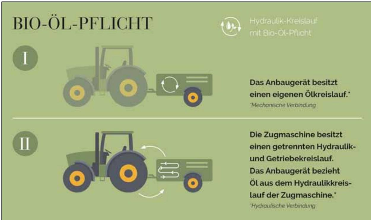
Übersicht zur Verwendung von Bio-Hydraulik-Öl in forstlichen Anbaugeräten © PEFC Bayern
